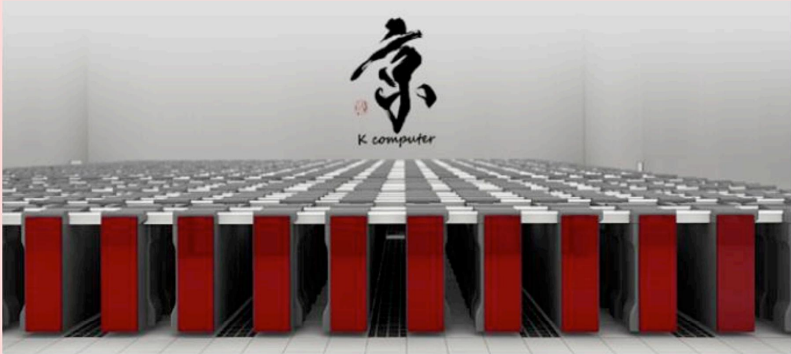
[그림 3] 일본 후지쓰사가 개발한 K 컴퓨터. 2011년 11월부터 현재까지 세계에서 제일 빠른 컴퓨터로 705,024 CPU 코어를 탑재하고 있으며, 10.51 페타플롭스 (초당 10^{15} 연산처리)의 성능을 가진다. 일본의 NICAM 기후모델을 이용한 태풍 예측, 400 m 공간해상도의 초고해상도 기후모델 개발 등에 활용되고 있다.
