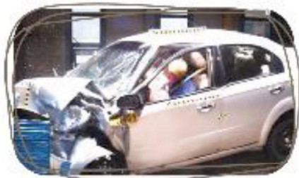
더미 인형을 이용한 시제차 충돌실험 장면
